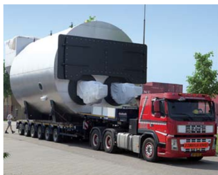
Транспортировка котла с двойной топкой
